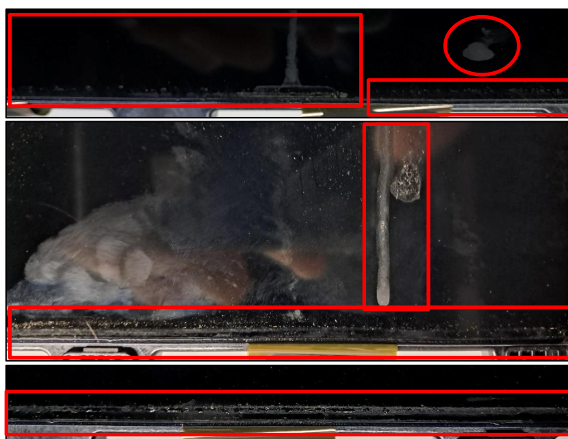
Figura 04 – Fotos do Módulo LCD sem o gabinete frontal, onde foi detectado presença de oxidação na parte inferior. Os circuitos localizados na região inferior do Módulo LCD foram afetados pelo contato com o líquido. Isso pode ocorrer de forma direta como por exemplo, queda de líquido no produto ou de forma indireta, durante o procedimento de limpeza com um pano molhado.
