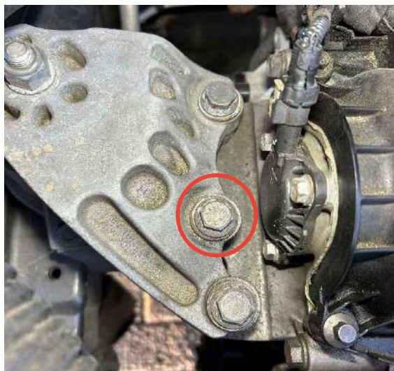
Marcas de retirada do coxim
