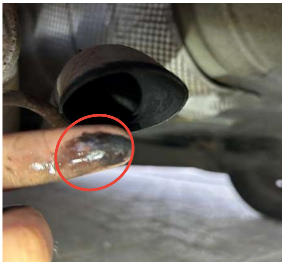
Presença de borra de óleo no escapamento
